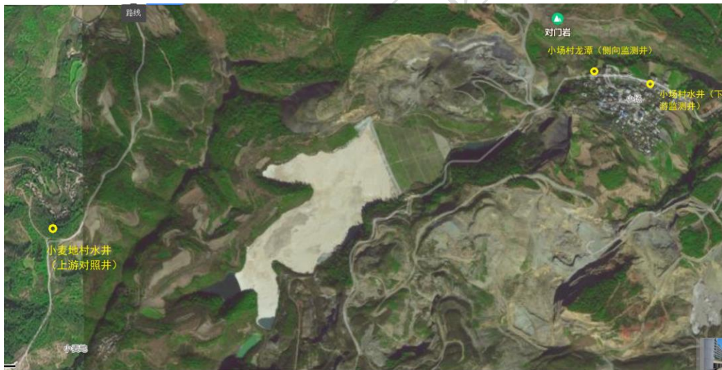
图 4.3-1 小麦地尾矿库地下水跟踪监测井
